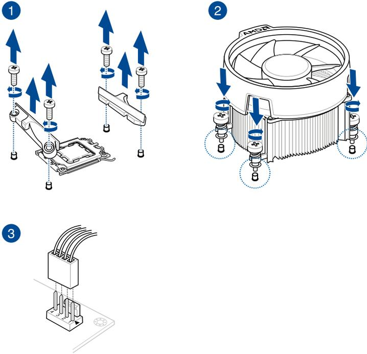
Lors de l'utilisation de ce type de ventilateur du processeur, retirez les vis et le module de rétention uniquement. Ne retirez pas la plaque du dessous.
